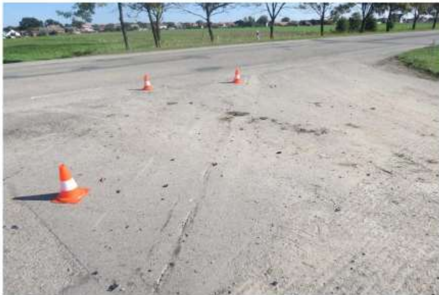
20. Celkový pohled na stopu č. 3 - rycí stopa motocyklu Yamaha, stopu č. 4 - vyteklá kapalina, stopu č. 5 - oblast stěpů a plastů - pohled proti směru pádu motocyklisty.
